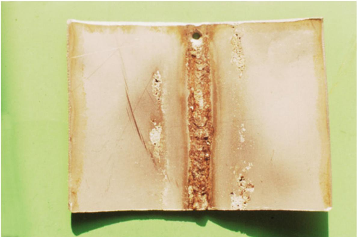
Corrosão em torno de cordão de solda em aço inoxidável.
