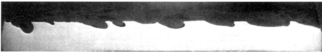
**Figura 43 - Corrosão por erosão de um tubo de condensador de latão apresentando forma de lágrimas.**
